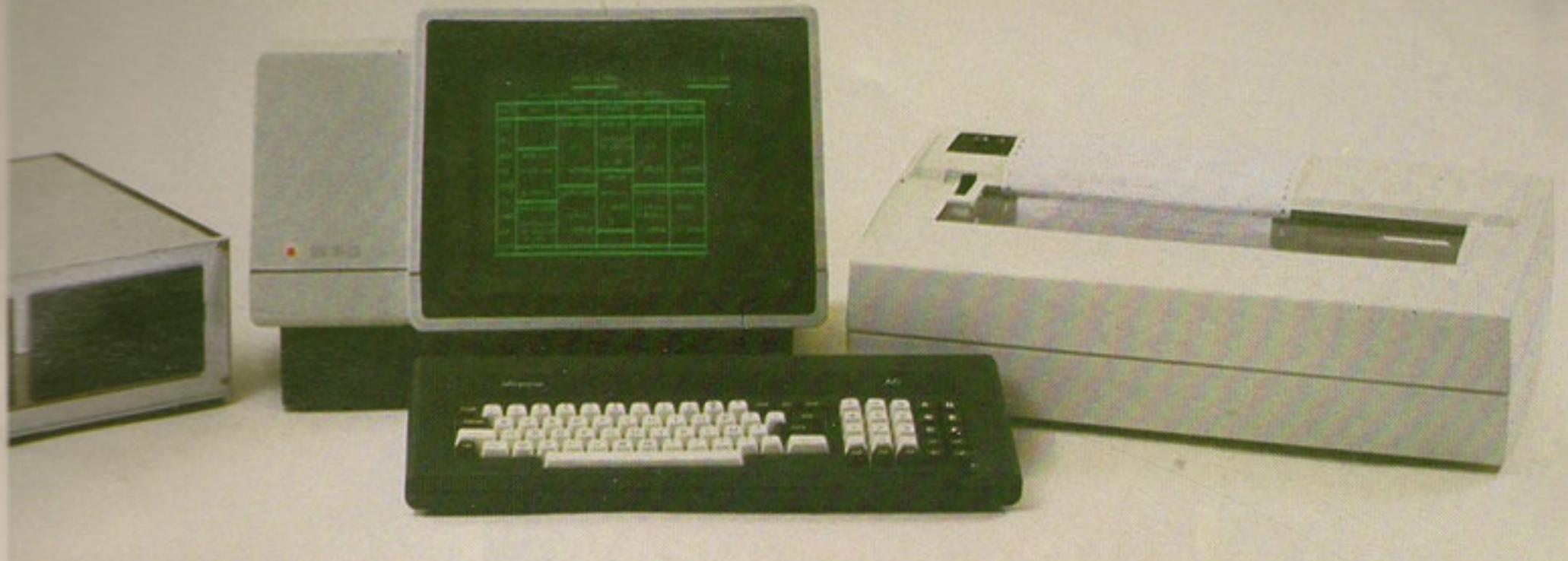
tions sont possibles : un coffret de deux lecteurs de disques souples (5" 1/4 double face, double densité), ou un à quatre coffrets d'un lecteur de disques souples (8" double face, double densité). Si on le désire, un à quatre disques durs de 10 M-octets peuvent être intégrés au système. Les lecteurs sont un peu encombrants, mais l'Alcyane A6E visant essentiellement une clientèle de PME/PMI, ce détail n'a qu'une relative importance.
